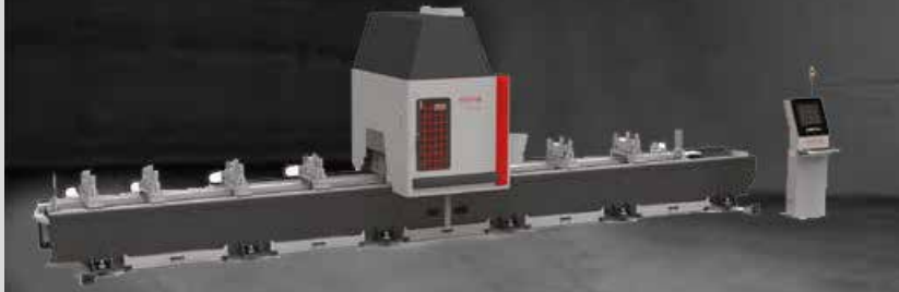
Centre d'usinage numérique 8m 5 axes
