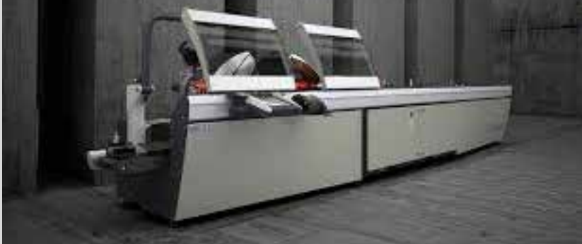
Centre d'usinage numérique 8m 5 axes
